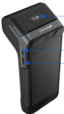
Бесконтактный способ считывания карточки
